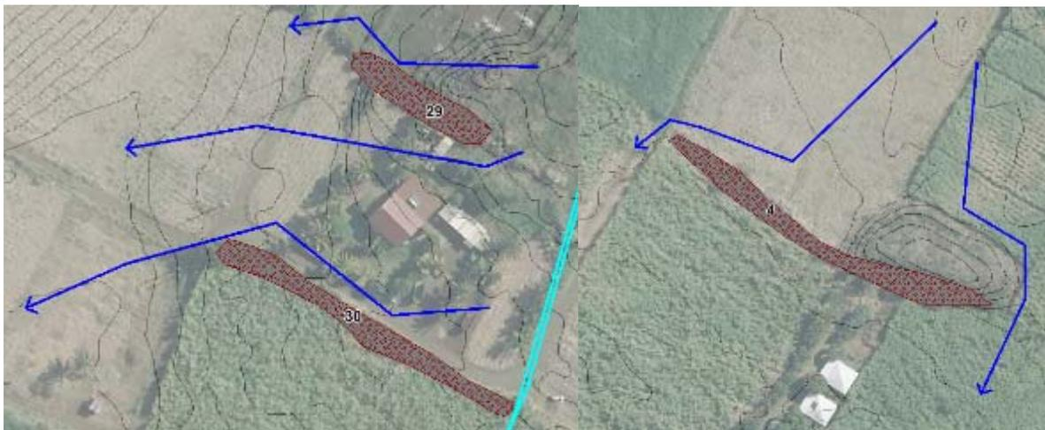
Figure 12 : Exemple d'andain perpendiculaire aux écoulements
