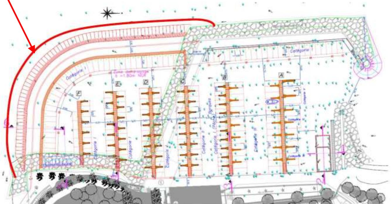
Figure 4.35 : rideau anti MES mis en place toute la durée du chantier (fin du chantier)
