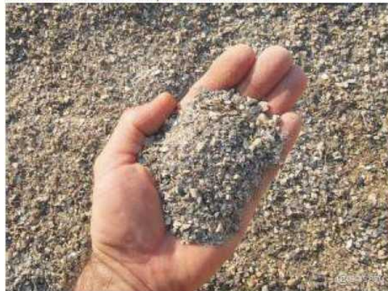
Granulats issus de coquilles concassées
