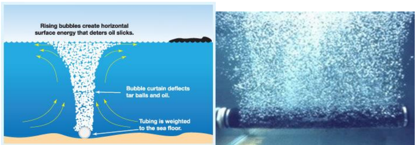
Figure 5.3 : Illustration du principe de fonctionnement d'un rideau de bulles
