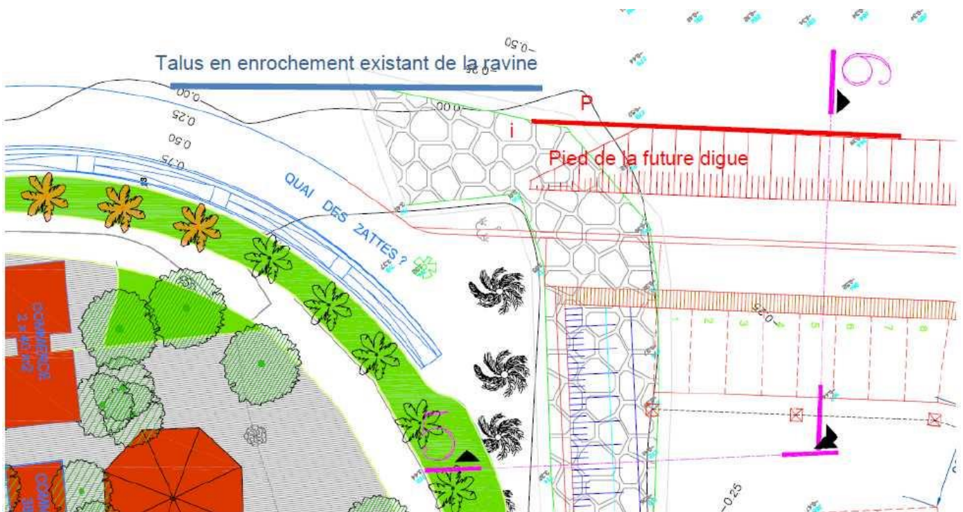
Figure 4.29 : Schéma justifiant la cohérence du projet vis-à-vis du gabarit hydraulique de la ravine Grand Étang
