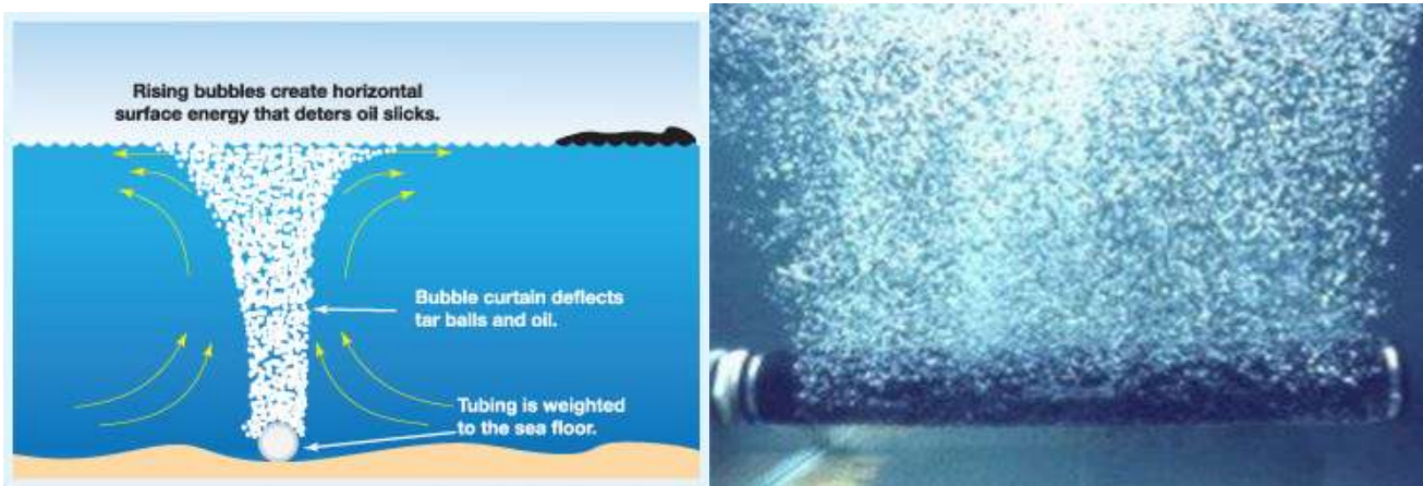
Figure 7.3 : Illustration du principe de fonctionnement d'un rideau de bulles
