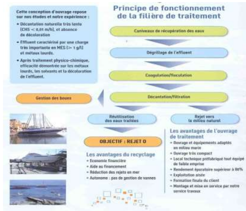
Figure 7.2 : Principe de fonctionnement de l'unité de traitement
