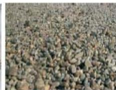
Matériaux servant au remplissage galet Ø5 à 10 cm
