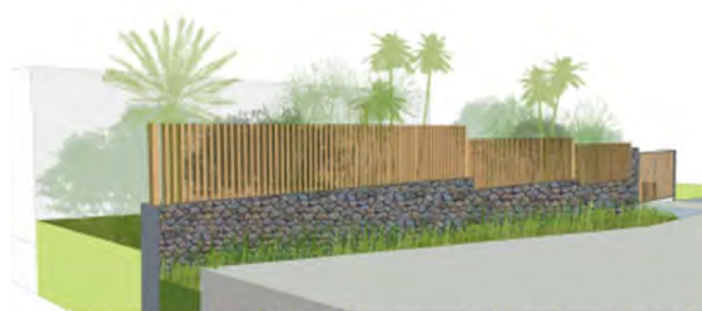
Croquis du traitement souhaité de la limite avec l'espace public : mur bahut de 30cm à 60cm surmonté d'un barreaudage bois de 140cm, doublé d'une haie vive
