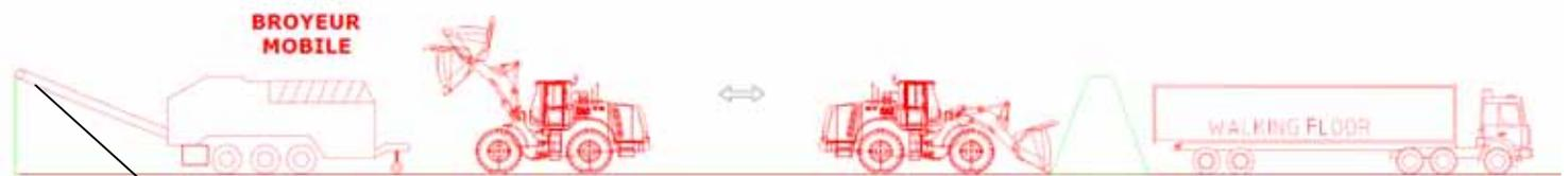
Planche 32 :Principe de réception, contrôle et broyage de la biomasse locale
