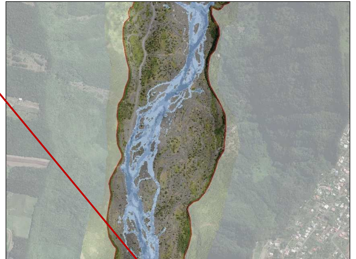
Evolution importante de la rive droite de la rivière des Remparts. Une quantité relativement importante de matériaux a été mobilisée lors des crues de 2018. Actuellement, les écoulements s'étalent davantage sur l'intégralité de la largeur du lit.
