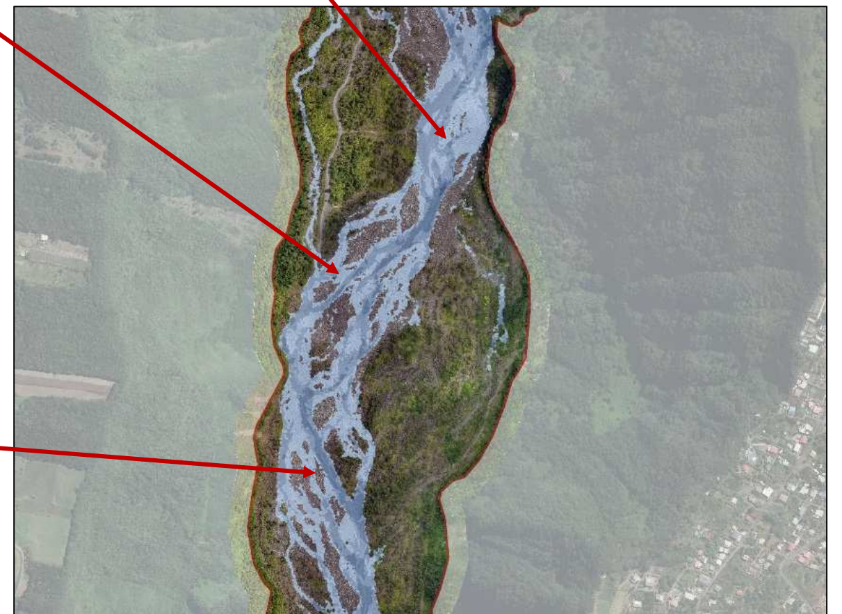
Accumulation de matériaux sur la zone de restauration du secteur des fosses : redistribution d'une partie des blocs mis en refus au sein du lit vif de la rivière des Remparts. L'axe d'écoulement préférentiel a très peu évolué entre 2017 et 2019.
