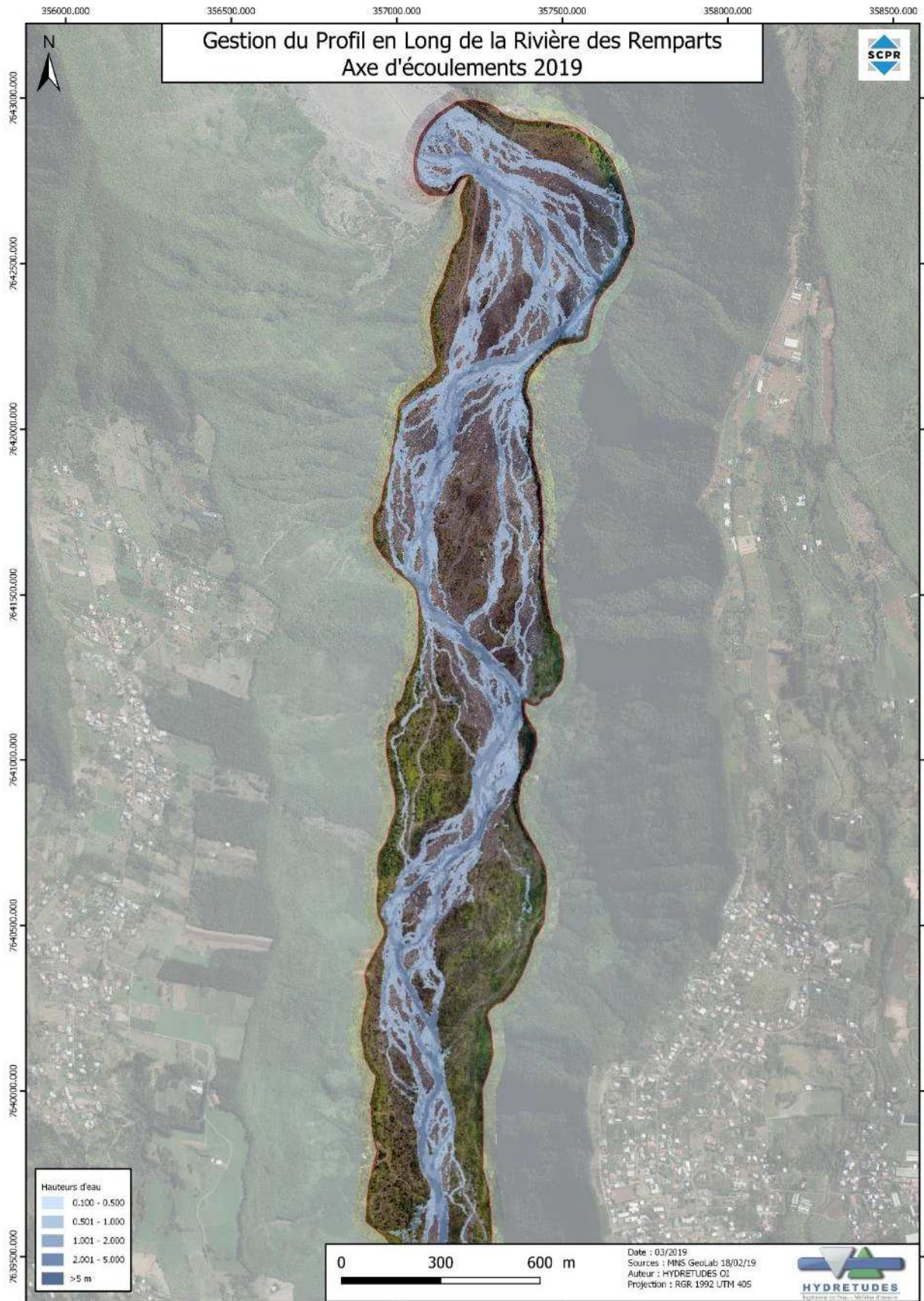
Figure 6: Cartographie des axes d'écoulements en 2019 au sein de la zone d'étude pour Q=200m^3/s
