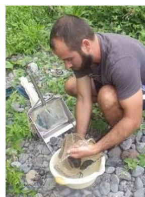
Figure 7 : Prélèvement au filet Surber (à gauche) et transfert des éléments de faune et de granulométrie en bassine (à droite).
