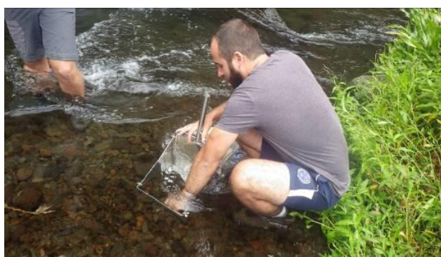
Figure 7 : Prélèvement au filet Surber (à gauche) et transfert des éléments de faune et de granulométrie en bassine (à droite).
