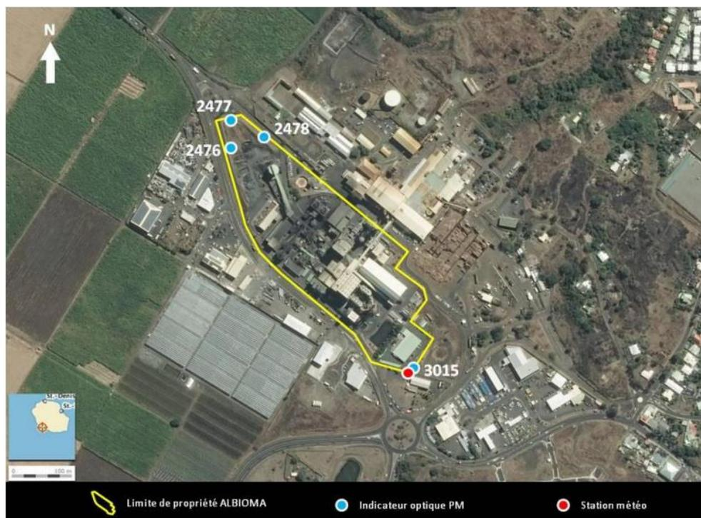
Figure 64. Localisation des différents emplacements instrumentés sur le site ALG
