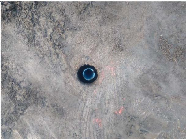
Photo 32 : Vue rapprochée Pz2 (Ouvrage temporaire non finalisé – margelle, capot – rebouché en fin de chantier)
