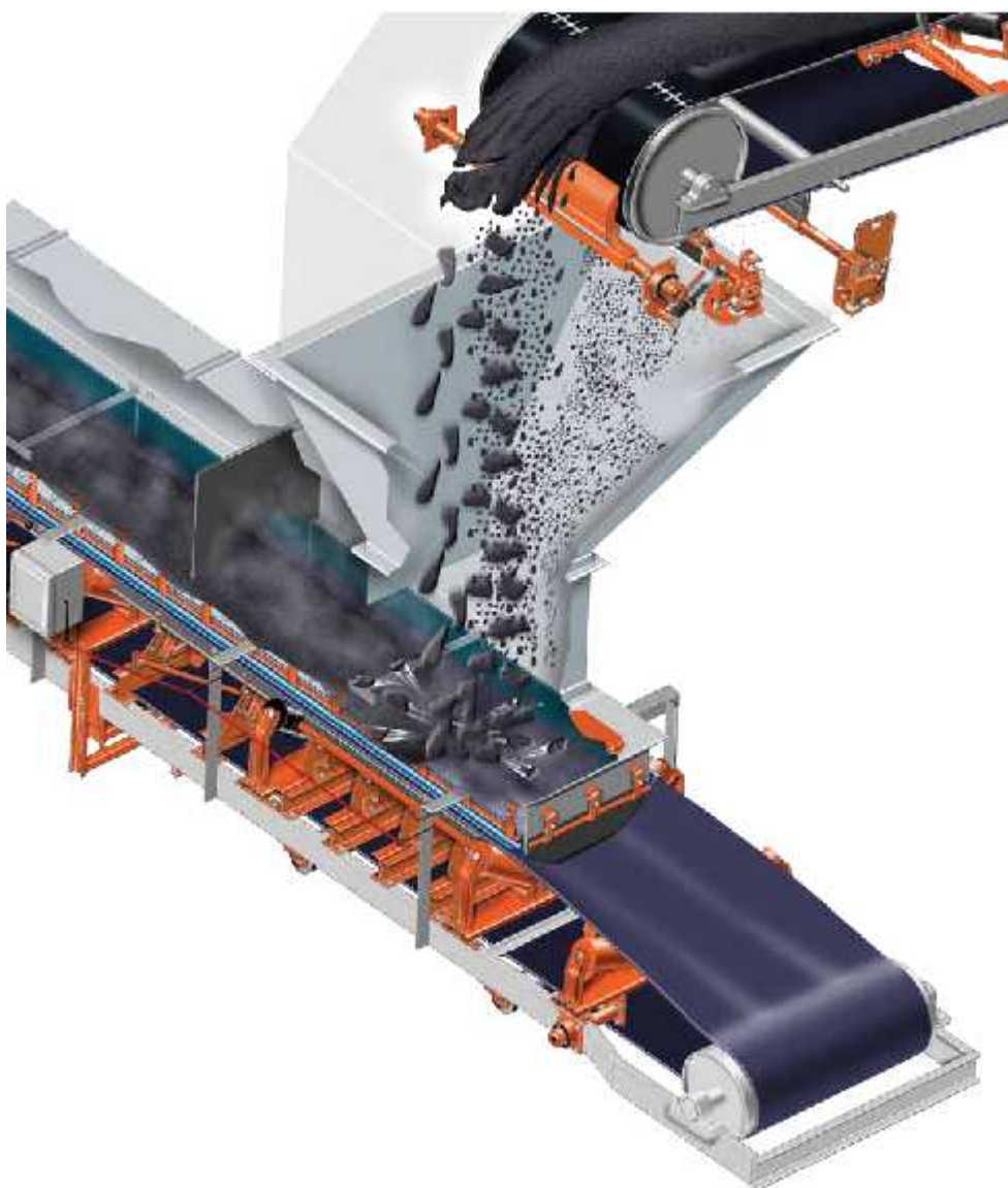
Figure 6 : Image d'un exemple d'une jonction entre convoyeurs (chute)
