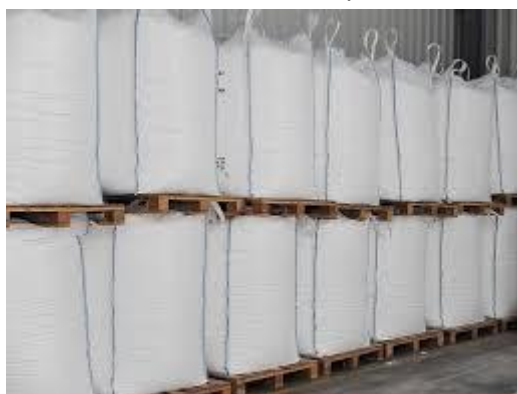
Figure 82: Exemple de stockage en big bag pour les métaux ferreux triés
