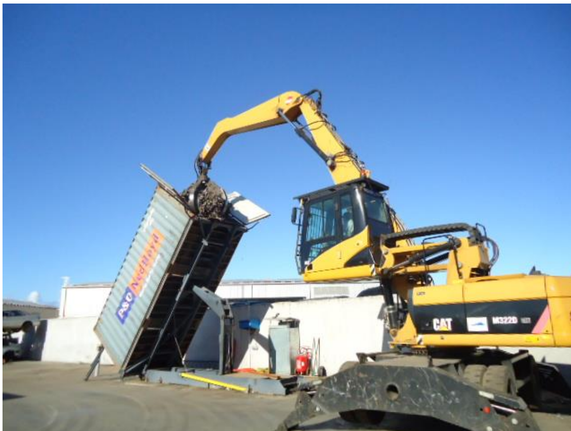
Figure 83: Illustration du principe du basculeur pour le chargement des conteneurs
