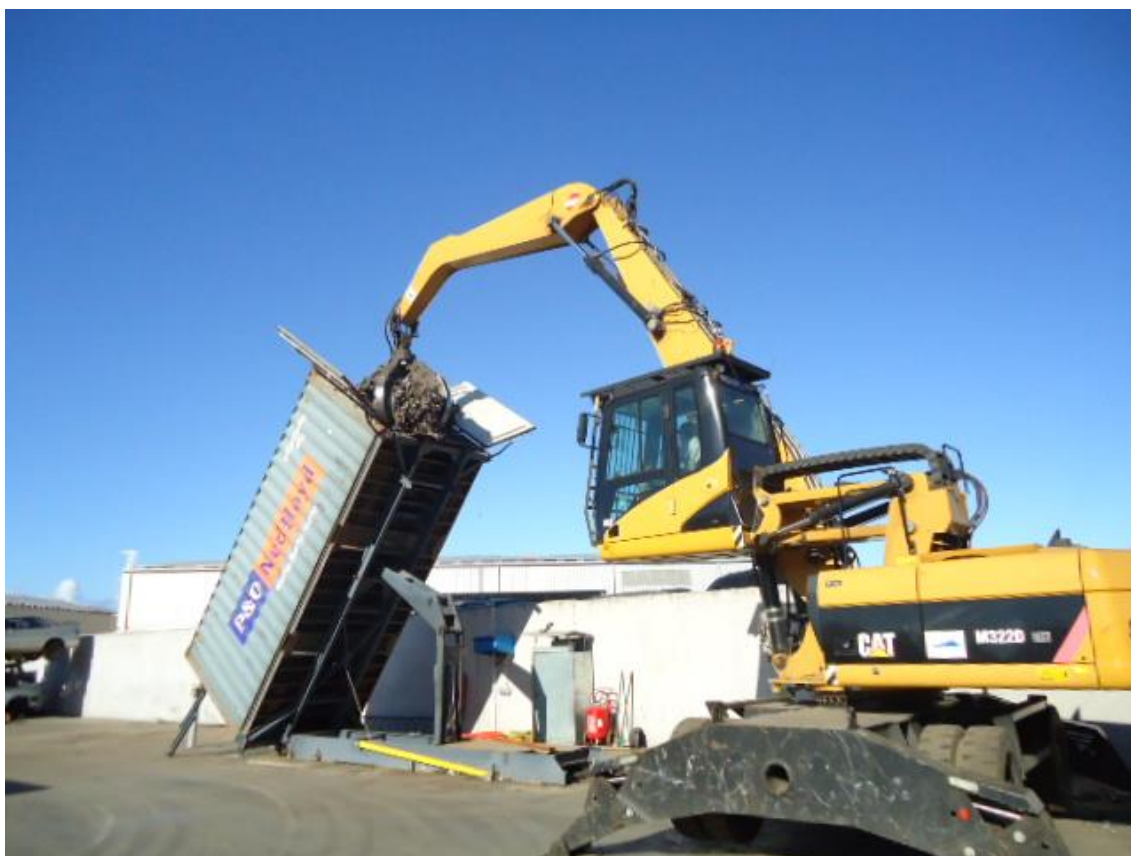
Figure 23: Illustration du principe du basculeur pour le chargement des conteneurs
