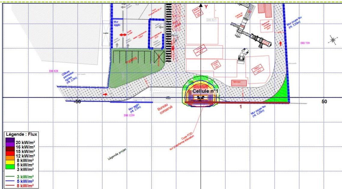
Figure 8 : Distances d'effets des flux thermiques d'un incendie de la cuve de rétention du stockage FOD
