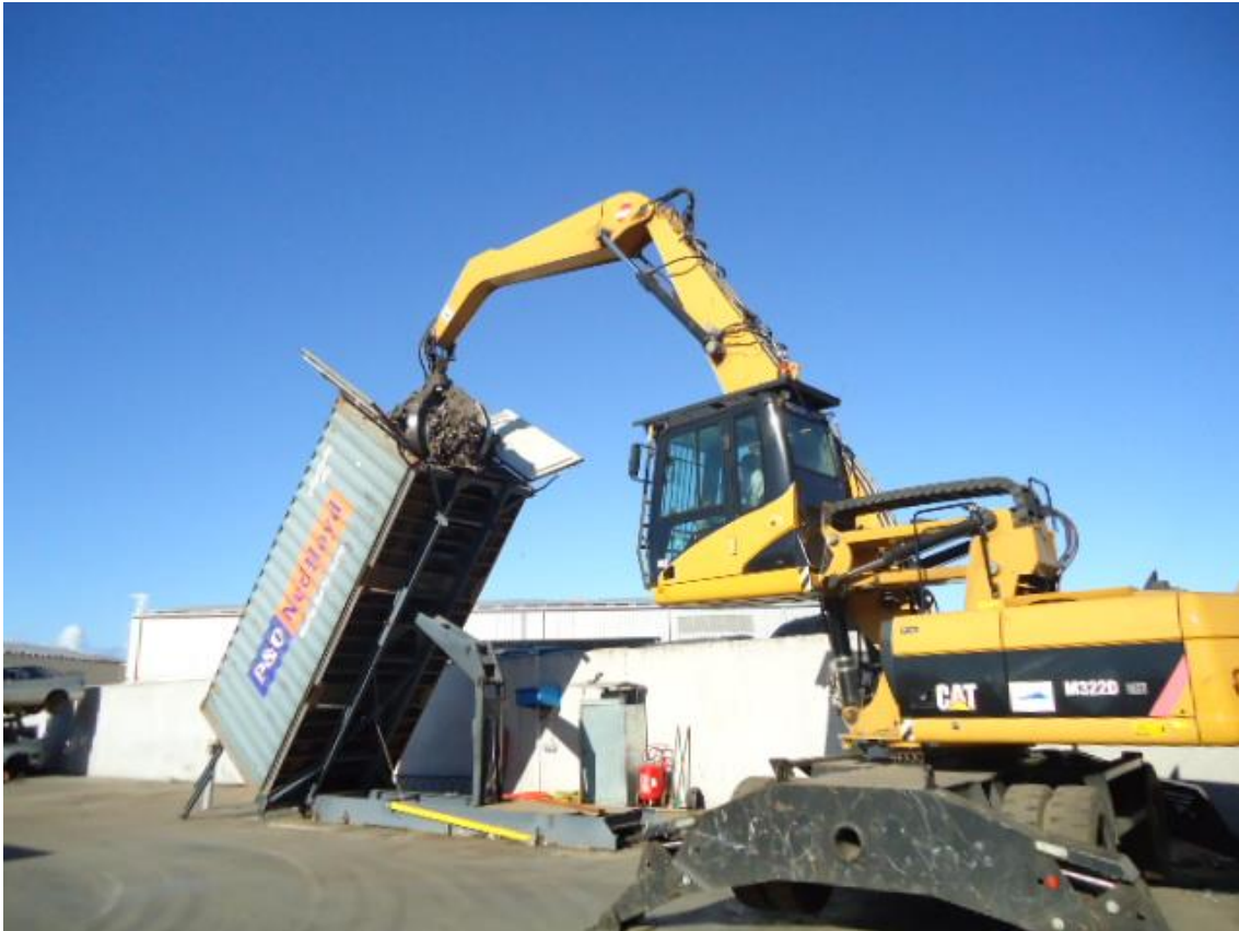
Figure 15: Illustration du principe du basculeur pour le chargement des conteneurs
