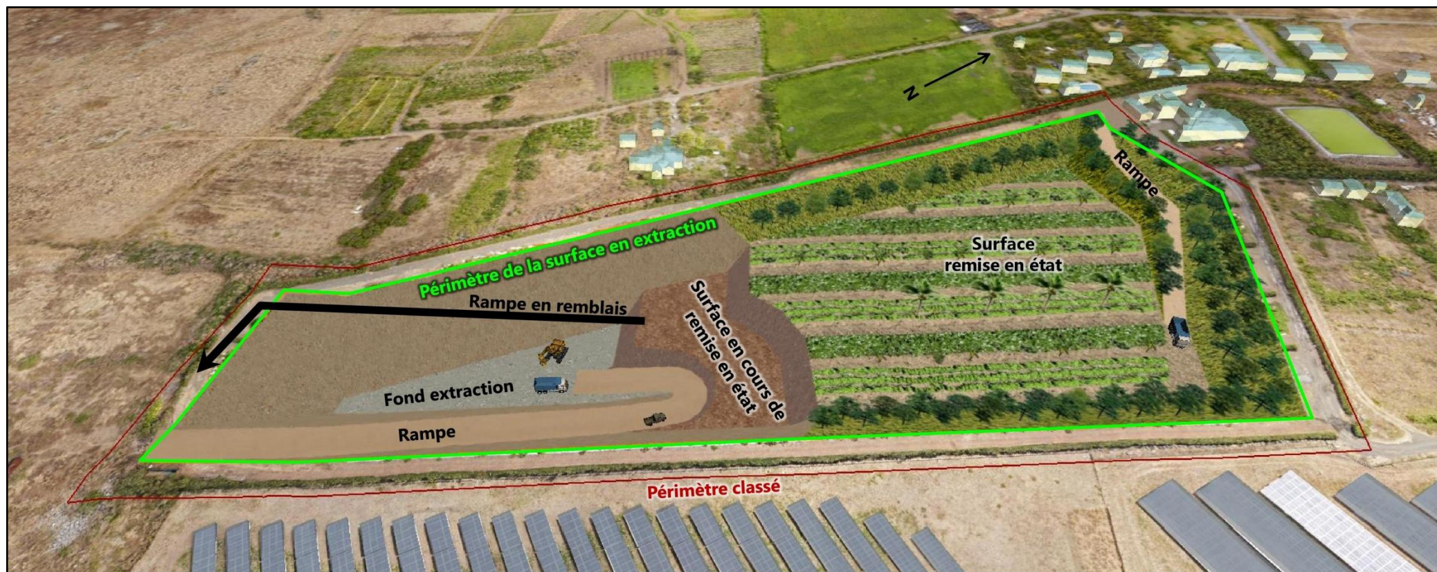
Planche 22 : Représentation en 3D du principe de l'exploitation en fin de phase 4
