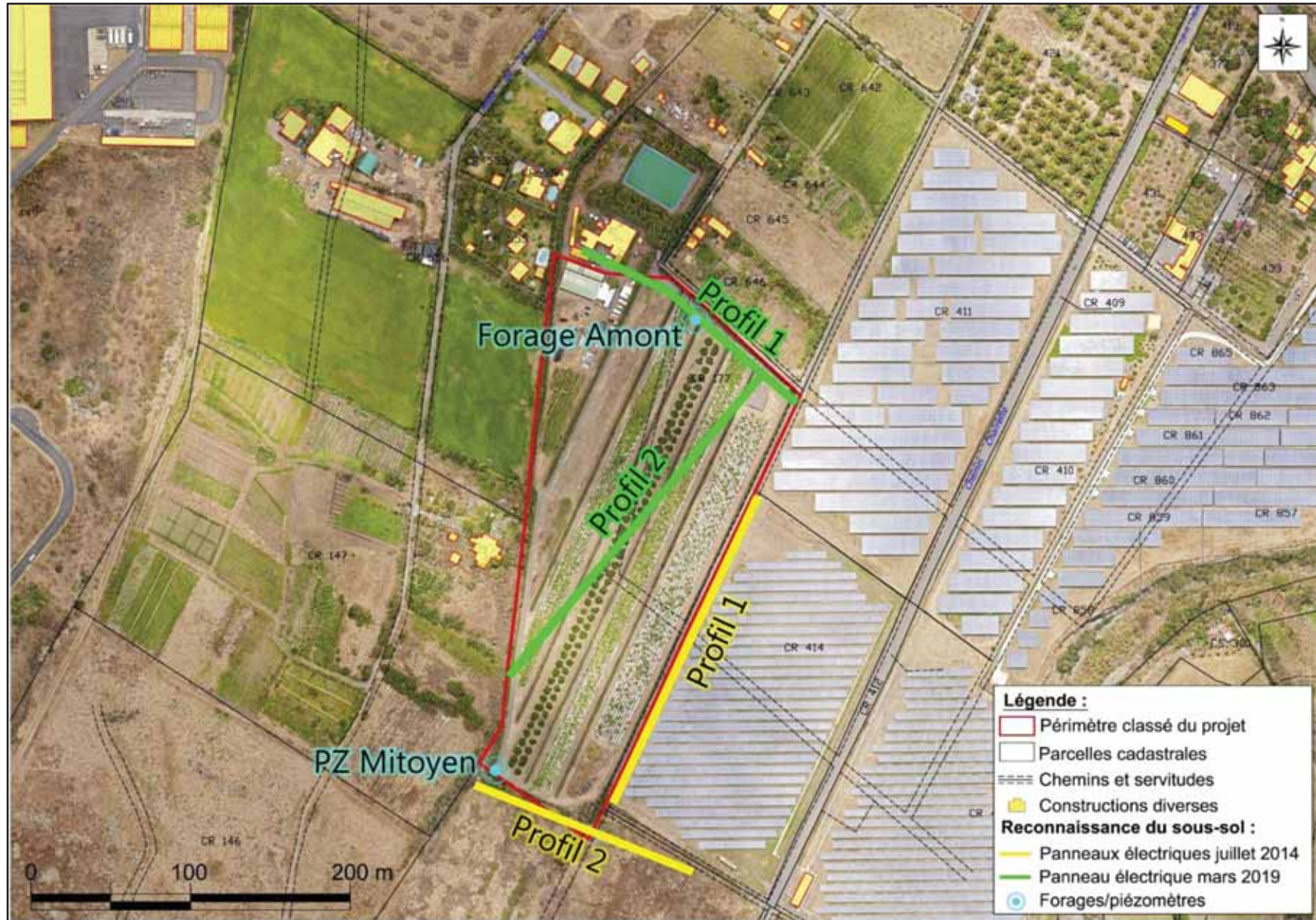
Planche 63 : Localisation des travaux de reconnaissance du sous-sol au droit du projet
