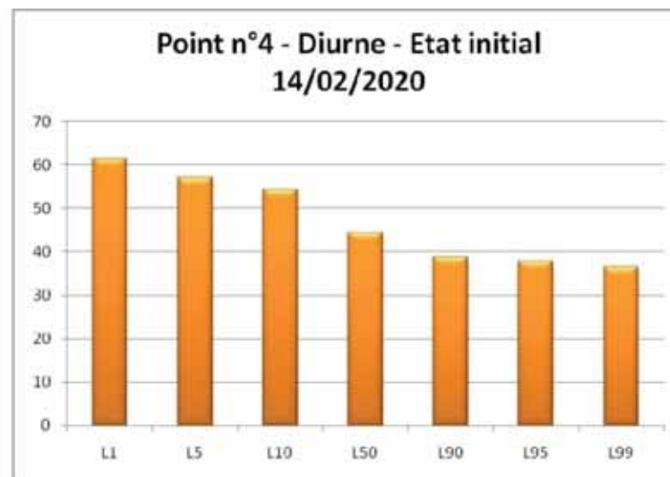
Planche 121 : Interprétation graphique des enregistrements des mesures de bruits en période diurne (Source : EMC 2 Environnement)
