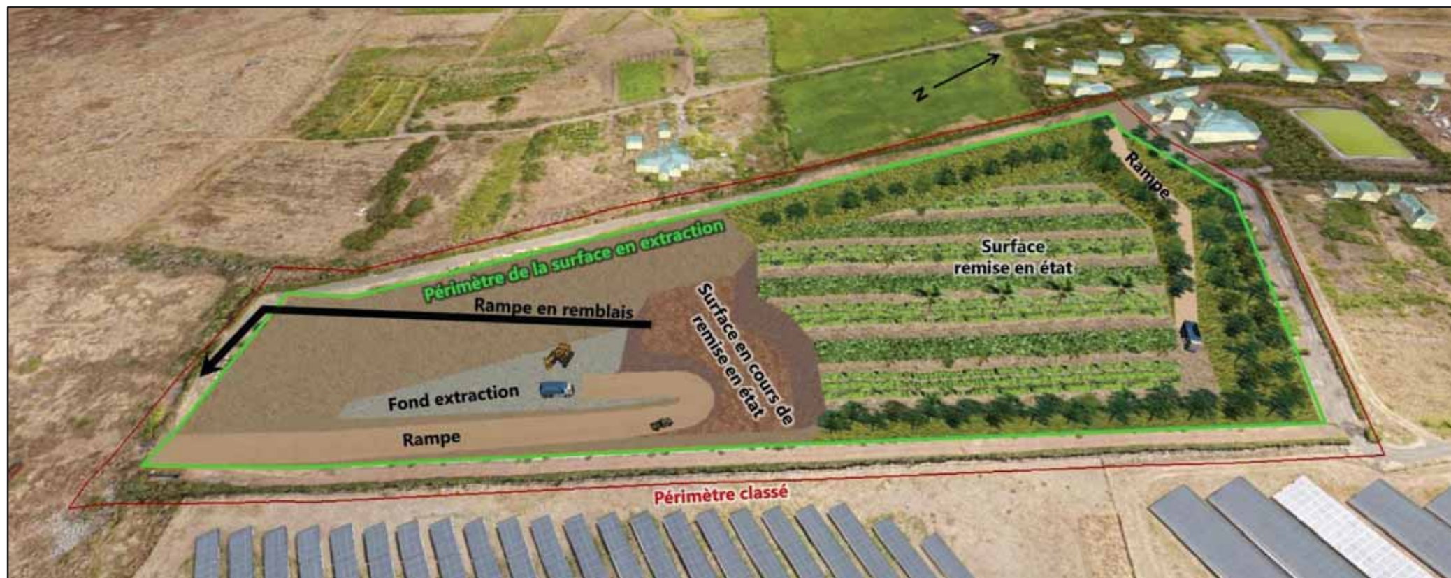
Planche 14 : Représentation en 3D du principe de l'exploitation en fin de phase 4
