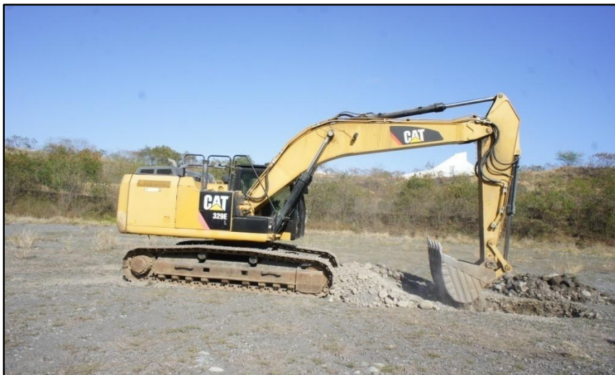
Planche 15 : Pelle mécanique de 30 tonnes utilisée pour les sondages (source : EMC2 Environnement)
