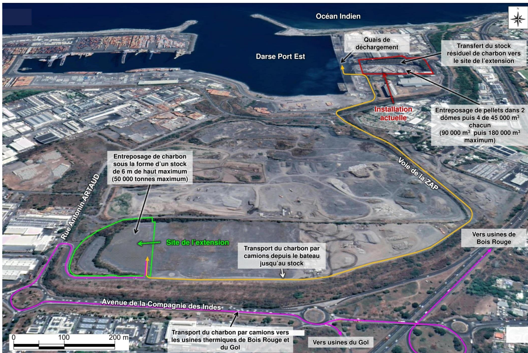
Planche 4 : Activité de stockage de charbon sur le site de l'extension (en début de phase 2 des travaux sur l'installation actuelle)
