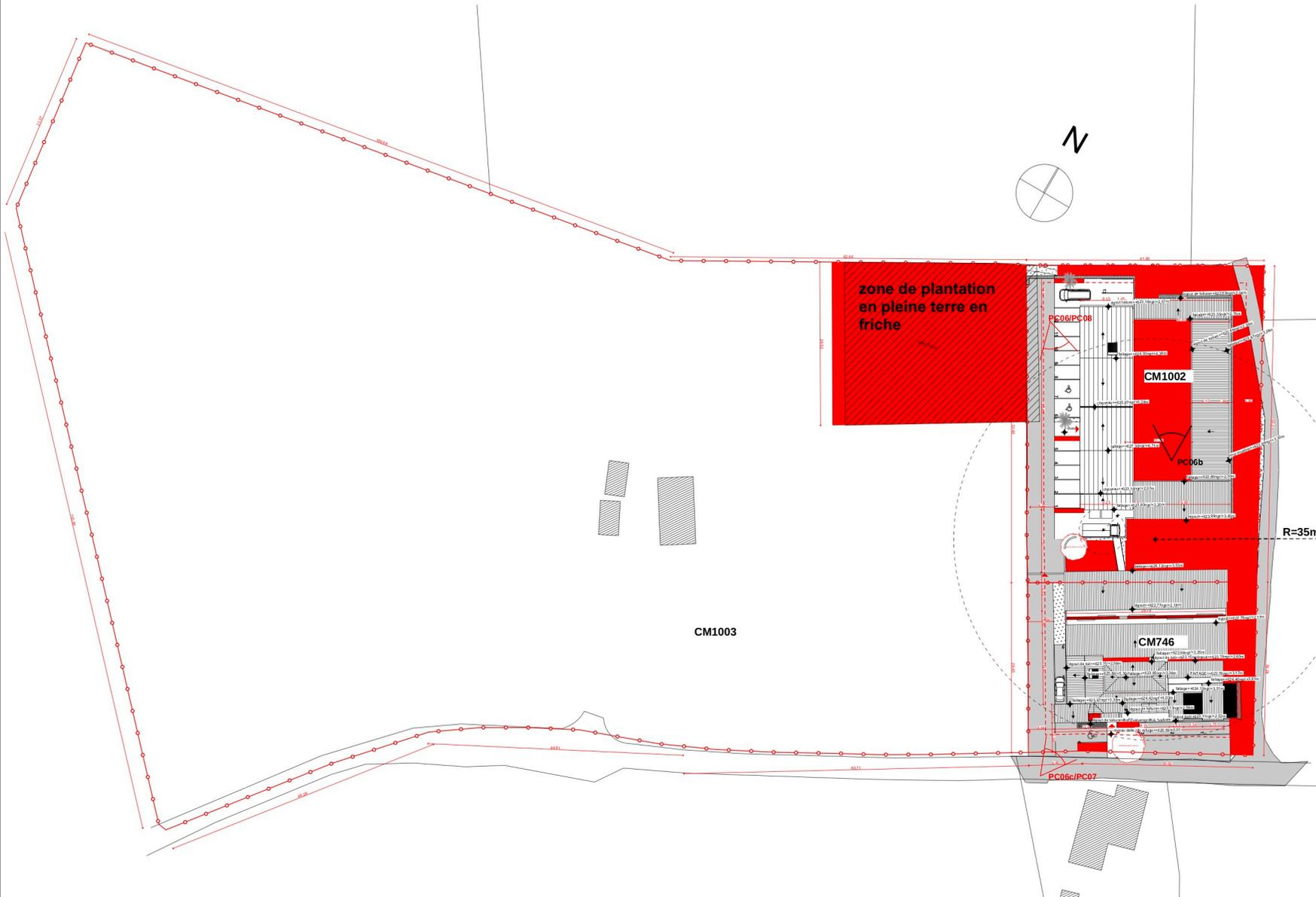
**PLU impose 60% de surface perméable en pleine terre. soit 2070m<sup>2</sup>.**
