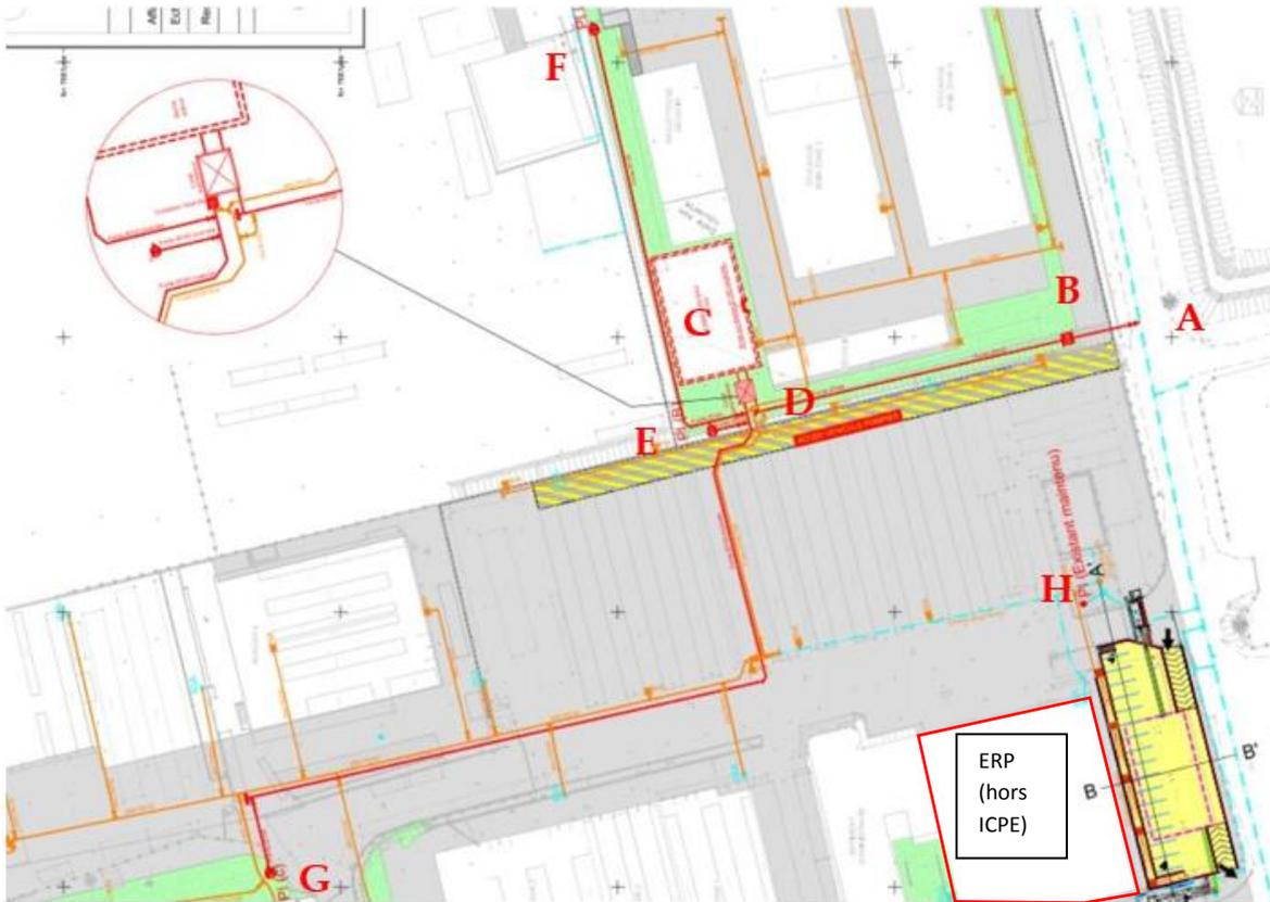
**Figure 61 – Fonctionnement du réseau de défense extérieure de lutte contre l'incendie (Réseau Rouge)**
