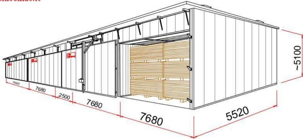
**Figure 52 : Vue schématique des futurs séchoirs**
