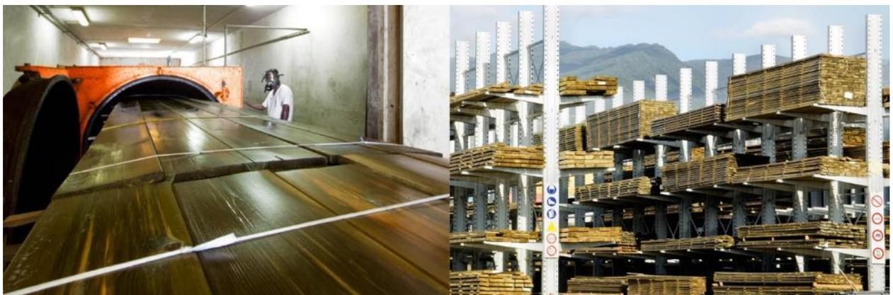
Figure 13 : Autoclave et stockage du bois traité
