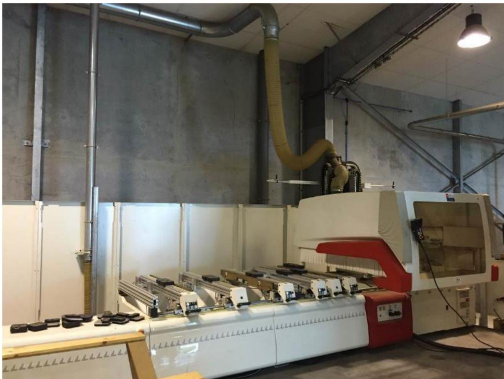
Figure 18 : Le centre de parçage, défonçage, gravure
