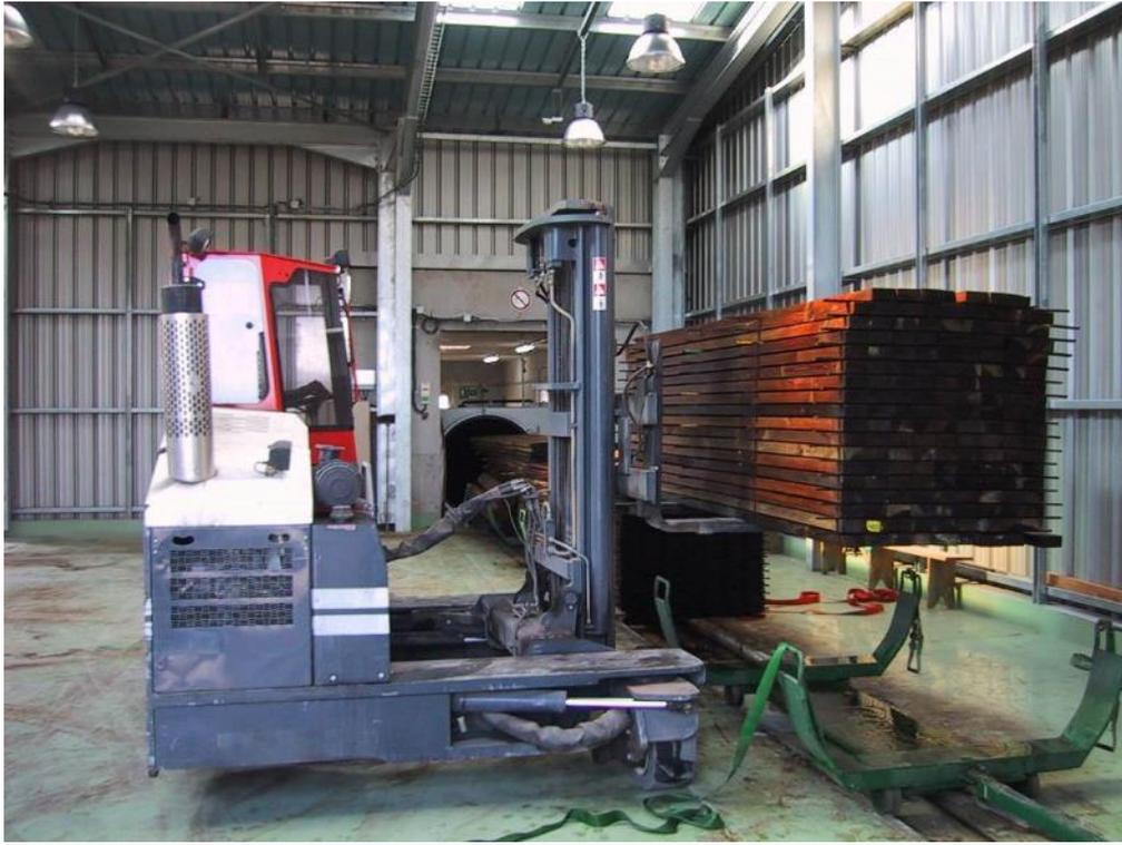
Figure 12 : Bois de conifères traités et autoclave de traitement
