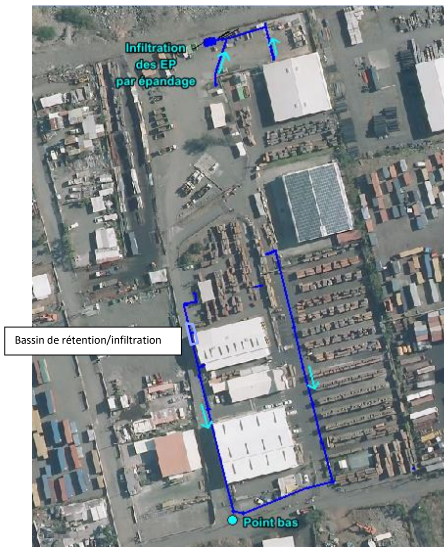
Figure 1 - Réseaux d'eaux pluviales existants
