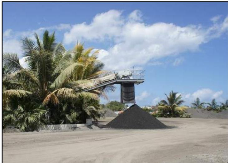
**Figure 46 : Mise en place de bâche sur les cribles et convoyeurs, manchettes en sortie des bandes transporteuses de la station fixe de traitement des inertes**
