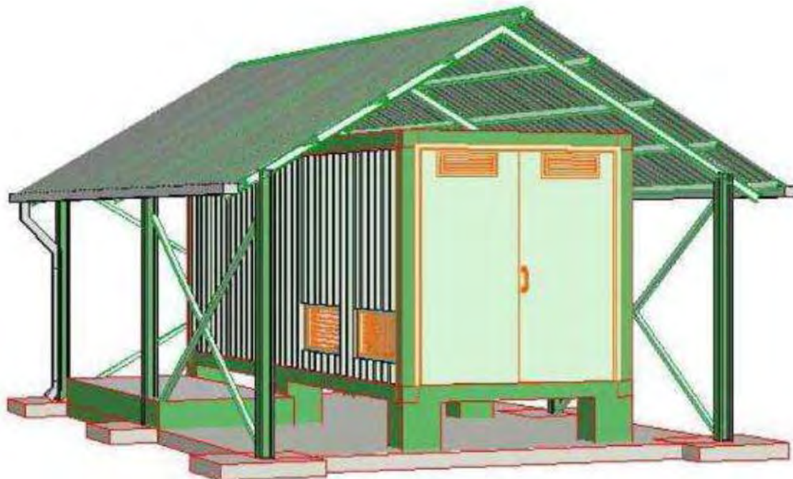
Fig. 9. Vue extérieure du conteneur onduleur et de son portique
