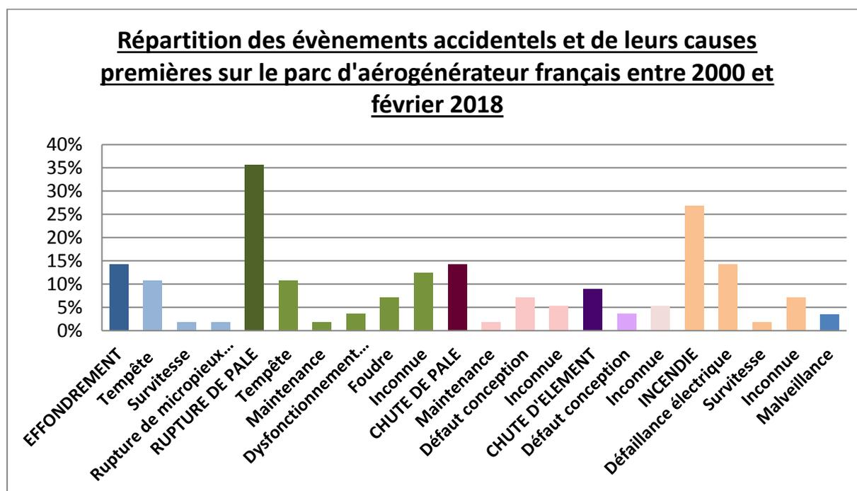
Par ordre d'importance, les accidents les plus recensés sont les ruptures de pale, les incendies, les effondrements, les chutes de pale et les chutes d'éléments d'éoliennes. La principale cause de ces accidents est la défaillance électrique.
