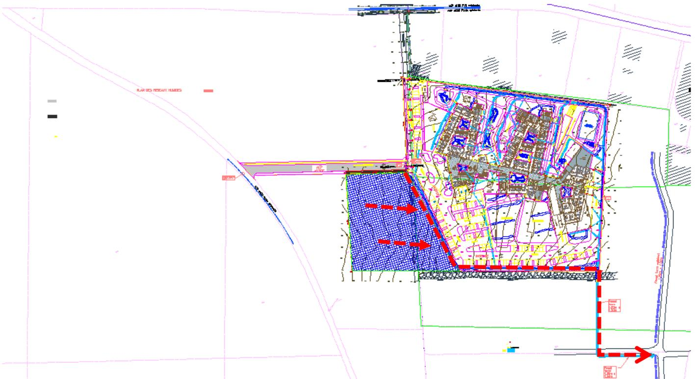
Figure 5 : Délimitation du bassin versant BV D et sens des écoulements
