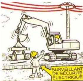
Lors de travaux sous ou à proximité de la ligne électrique, un surveillant électrique formé et habilité minimum BOHO sera désigné et sera présent en permanence pour s'assurer visuellement du respect de la distance de sécurité lors des manœuvres réalisées par l'opérateur de l'engin.
