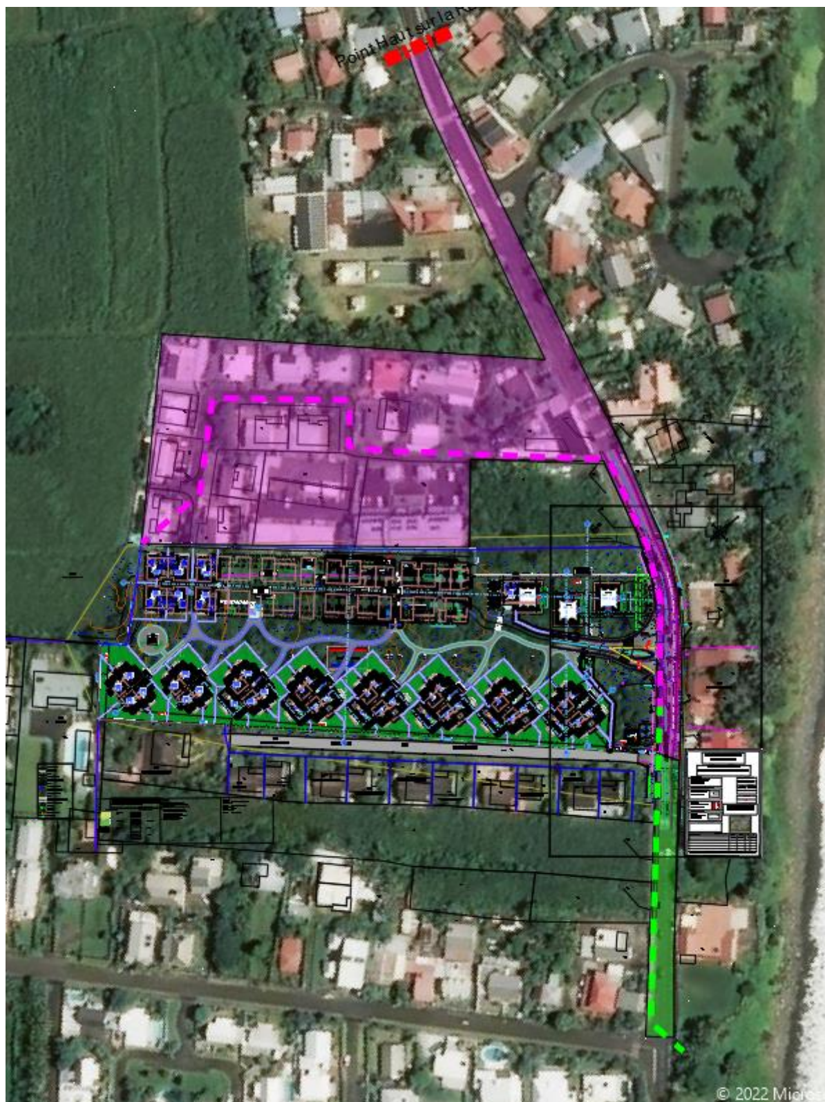
Figure 4 : Détermination des bassins versants (Source : KHEOPS DEVELOPPEMENT, 2022)
