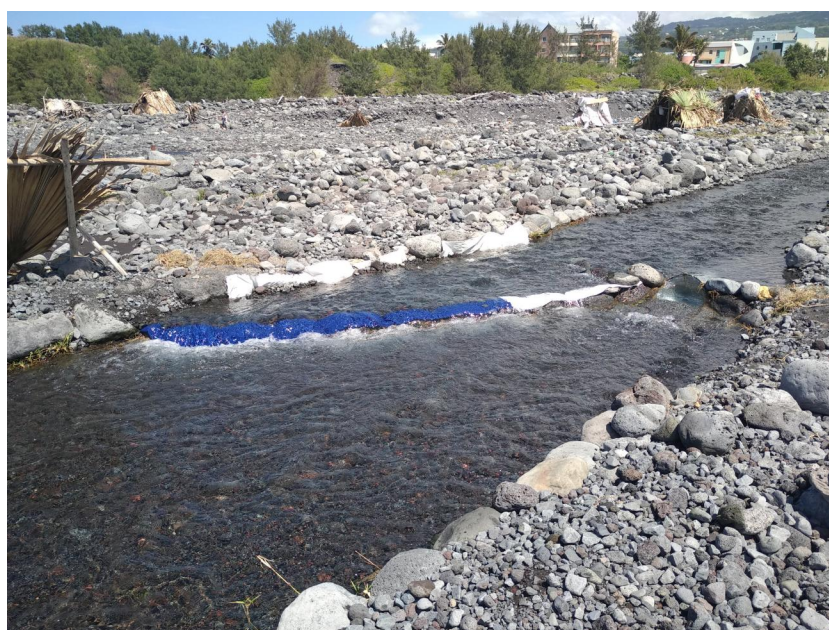
Figure 5 : Déversoir et voue en action de pêche sur la rivière des Remparts (OCEA, 2018).
